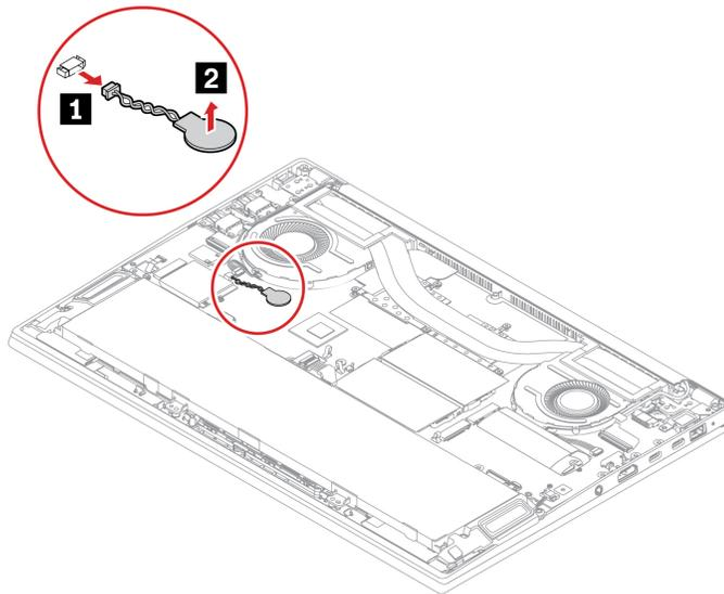
6. Setzen Sie die neue Knopfzellenbatterie **1** ein und schließen Sie dann den Stecker **2** an.
