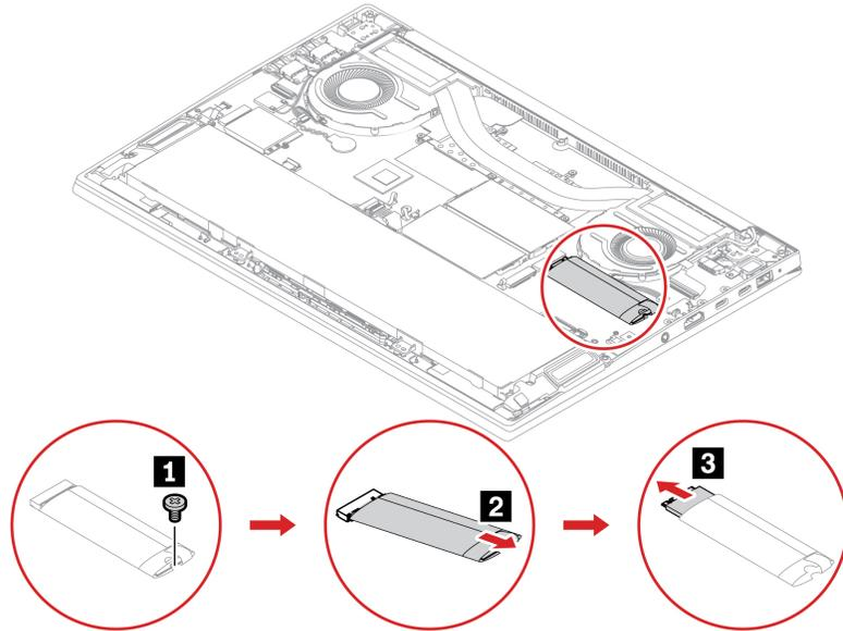
6. Installieren Sie ein neues M.2 Solid-State-Laufwerk:
