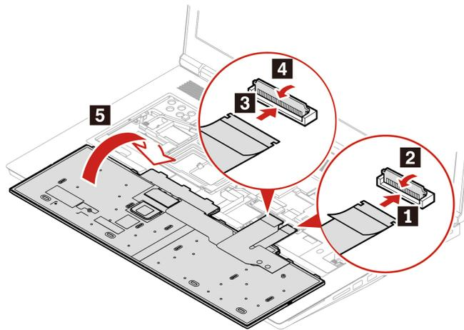
9. Insérez le clavier dans le panneau du clavier comme indiqué. Assurez-vous que le bord supérieur du clavier (le bord du côté de l'écran) est sous le panneau du clavier.
