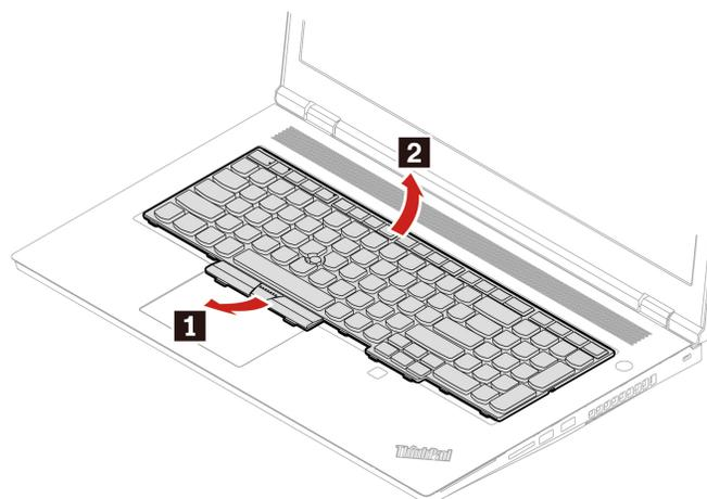
7. Placez le clavier sur le repose-mains, comme indiqué, puis débranchez les connecteurs **1** à **4** indiqués. Retirez ensuite le clavier.
