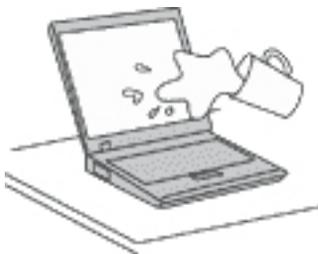
Bewahren Sie in der Nähe des Computers keine Flüssigkeiten auf, um das Verschütten von Flüssigkeiten auf dem Computer und die Gefahr eines elektrischen Schlags zu vermeiden.
