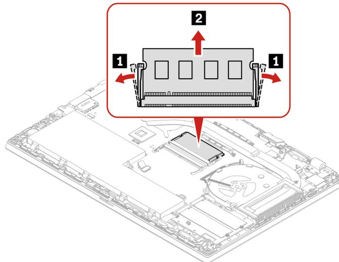
7. Installieren eines neuen Speichermoduls:
