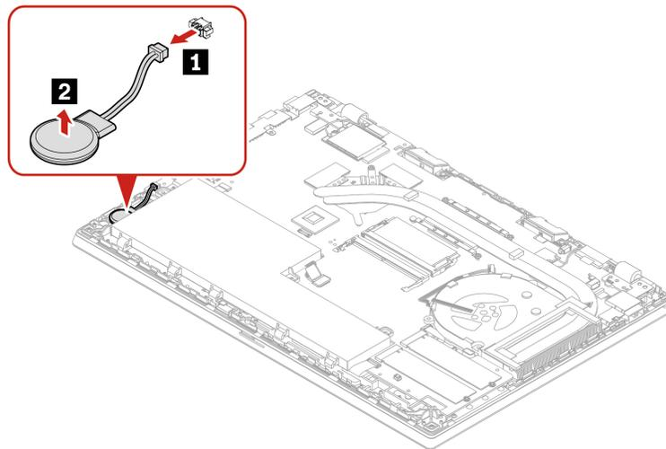
7. Setzen Sie die neue Knopfzellenbatterie **1** ein und schließen Sie dann den Stecker **2** an.
