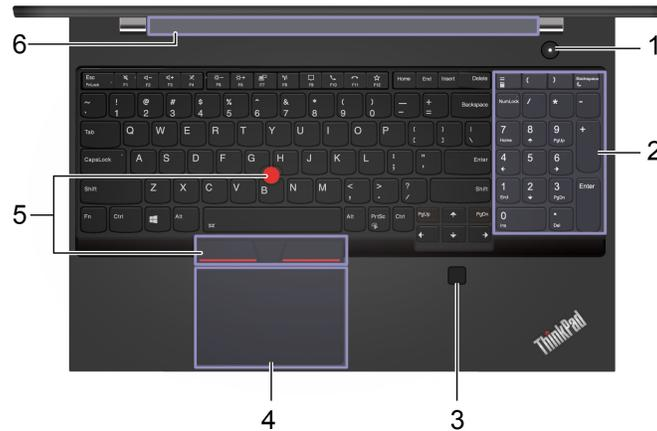
Drücken Sie diesen, um den Computer einzuschalten oder in den Energiesparmodus zu versetzen.
