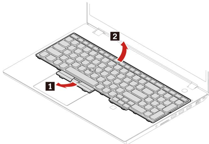
6. Legen Sie die Tastatur auf die Handablage, wie in der Abbildung dargestellt, und ziehen Sie die Steckverbinder ab. Entfernen Sie anschließend die Tastatur.
