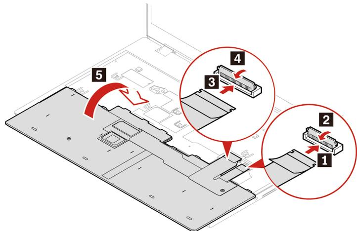
8. Setzen Sie die Tastatur wie abgebildet in die Tastaturblende ein. Vergewissern Sie sich, dass sich die obere Kante der Tastatur (die zum Bildschirm weisende Kante) unter der Tastaturblende befindet.
