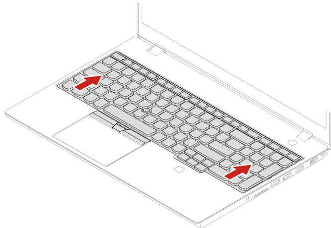
5. Neigen Sie die Tastatur leicht in die von Pfeil **1** angegebene Richtung und drehen Sie dann die Tastatur um **2**.
