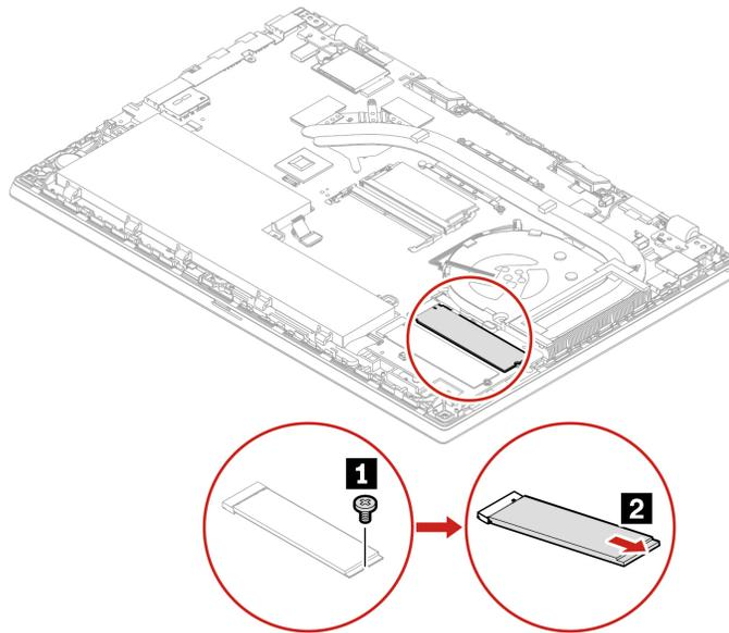
7. Installieren Sie ein neues M.2 Solid-State-Laufwerk:
