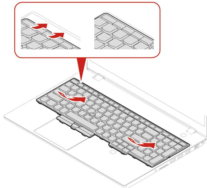
9. Schieben Sie die Tastatur in die dargestellte Richtung. Vergewissern Sie sich, dass die Verriegelungen unter dem Tastaturrahmen gesichert sind.
