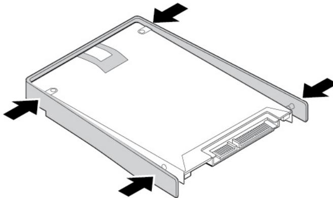
2. Installieren Sie das neue Speicherlaufwerk mit der Halterung. Stellen Sie sicher, dass das neue Speicherlaufwerk eingerastet ist.
