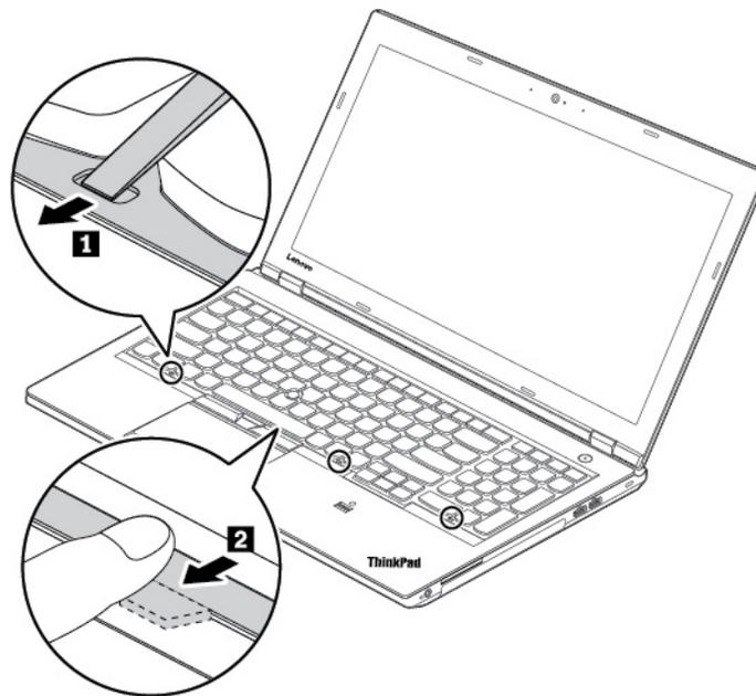
6. Drücken Sie den Tastaturrahmen in Richtung Trackpad. Stellen Sie sicher, dass zwischen dem Tastaturrahmen und der Tastaturblende kein Spalt ist.
