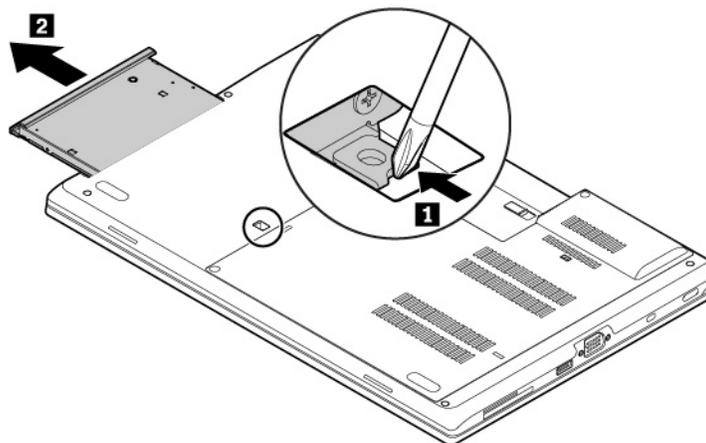
6. Setzen Sie ein neues optisches Laufwerk in Position für das optische Laufwerk ein. Drücken Sie das Laufwerk anschließend fest in den Steckplatz.
