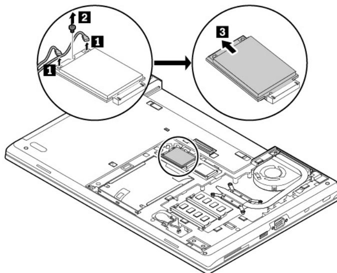
6. Installieren Sie eine neue Karte für drahtlose WAN-Verbindungen, indem Sie wie folgt vorgehen:
