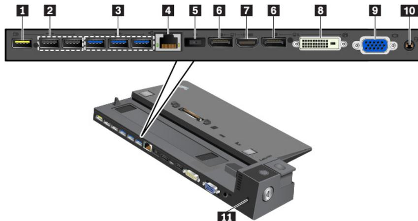
**1 Always On USB 2.0-Anschluss:** Zum Anschließen von USB-kompatiblen Einheiten oder zum Aufladen einiger digitaler Mobileinheiten und Smartphones.
