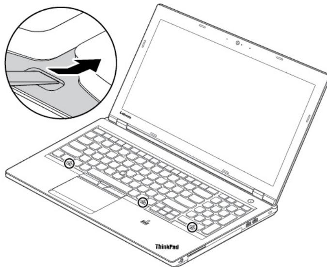
4. Ziehen Sie die Schrauben zur Befestigung der Tastatur wieder an.
