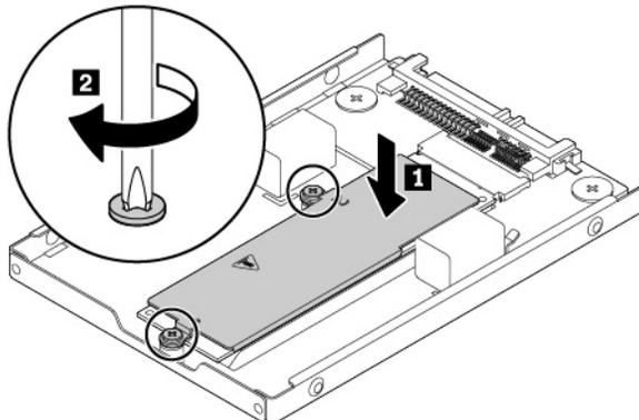
3. Installieren Sie den neuen Adapter des M.2-Solid-State-Laufwerks.
