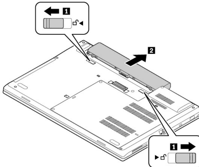
4. Setzen Sie einen neuen Akku so ein, dass er hörbar einrastet.
