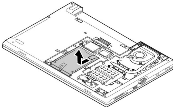
6. Entfernen Sie die Halterung des Speicherlaufwerks.
