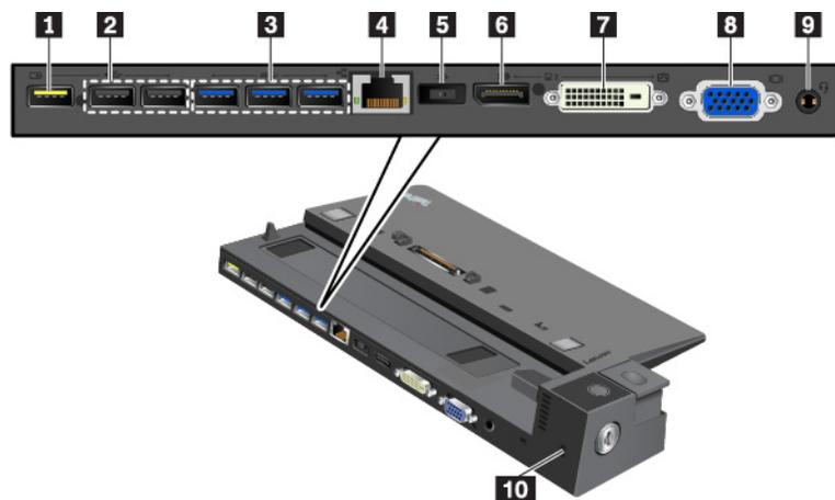
**1 Always On USB 2.0-Anschluss:** Zum Anschließen von USB-kompatiblen Einheiten oder zum Aufladen einiger digitaler Mobileinheiten und Smartphones.
