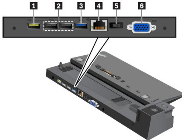
**1 Always On USB 2.0-Anschluss:** Zum Anschließen von USB-kompatiblen Einheiten oder zum Aufladen einiger digitaler Mobileinheiten und Smartphones.
