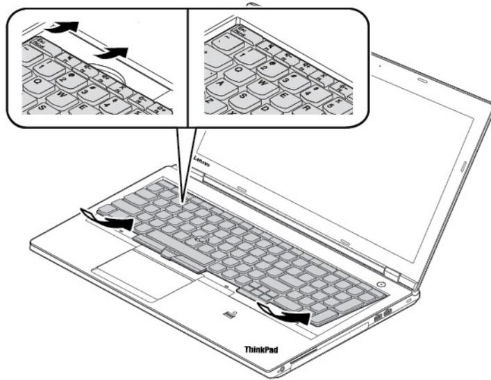
3. Stellen Sie sicher, dass die Schraubenköpfe vollständig freigelegt sind. Sollte das nicht der Fall sein, legen Sie die Schraubenköpfe frei, indem Sie den Tastaturrahmen in Richtung Bildschirm schieben.
