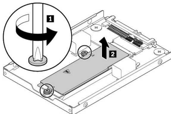
7. Heben Sie das M.2-Solid-State-Laufwerk etwas an und ziehen Sie es aus dem Steckplatz.
