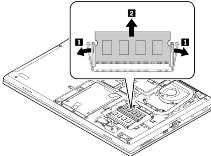
6. Setzen Sie das neue Speichermodul in einem Winkel von etwa 20 Grad in den Speichersteckplatz ein **1**. Klappen Sie das Speichermodul nach unten, bis es hörbar einrastet **2**. Wenn Sie nur ein Speichermodul installieren, verwenden Sie den Steckplatz **a**. Stellen Sie sicher, dass das Speichermodul fest im Speichersteckplatz installiert ist und nur schwer bewegt werden kann.
