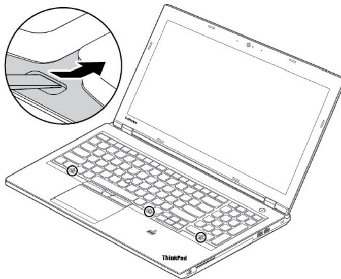
6. Lösen Sie die Schrauben.
