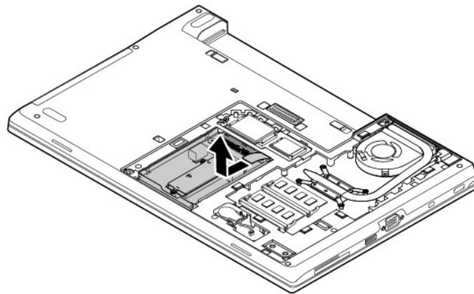
6. Entfernen Sie die Schrauben **1**, mit denen die Schutzabdeckung gesichert ist. Entfernen Sie anschließend die Abdeckung **2**.
