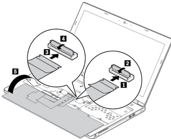
2. Setzen Sie die Tastatur in die Tastaturblende ein. Stellen Sie sicher, dass sich die vordere Kante der Tastatur (die zum Bildschirm weisende Kante) unter dem Rahmen der Tastaturblende befindet.
