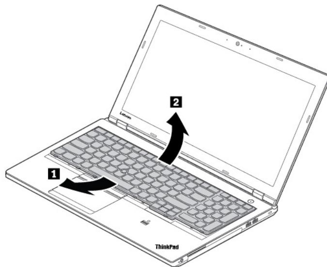
8. Legen Sie die Tastatur auf die Handablage und ziehen Sie die Stecker ab. Anschließend entfernen Sie die Tastatur.
