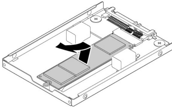
Gehen Sie wie folgt vor, um ein neues M.2-Solid-State-Laufwerk in der internen Speicherlaufwerkposition zu installieren:
