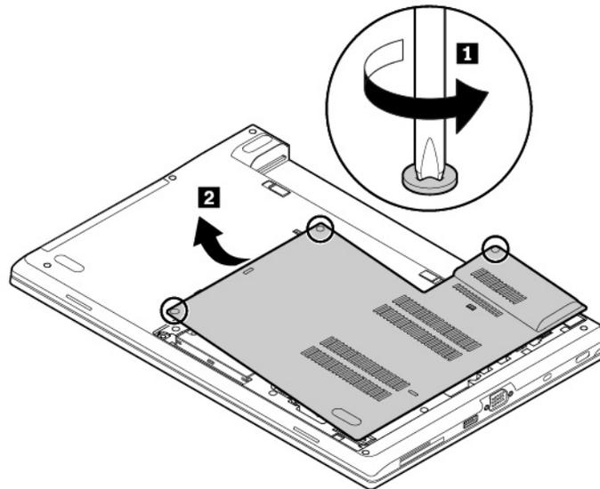
5. Bringen Sie eine neue untere Abdeckung an **1**/**2**. Vergewissern Sie sich, dass die Verriegelungen der unteren Abdeckung unter der Baugruppe der Grundplattenabdeckung gesichert sind. Ziehen Sie daraufhin die Schrauben fest, um die untere Abdeckung zu befestigen **3**.
