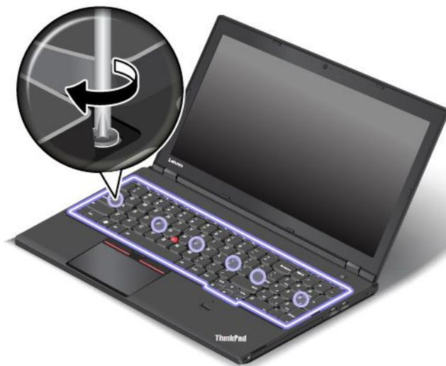
5. マイナス・ドライバーでキーボード・フレームを後方に2.5 mm (0.1 インチ) スライドさせて、キーボード・フレームのラッチをキーボード・ベゼルの下に隠します。
