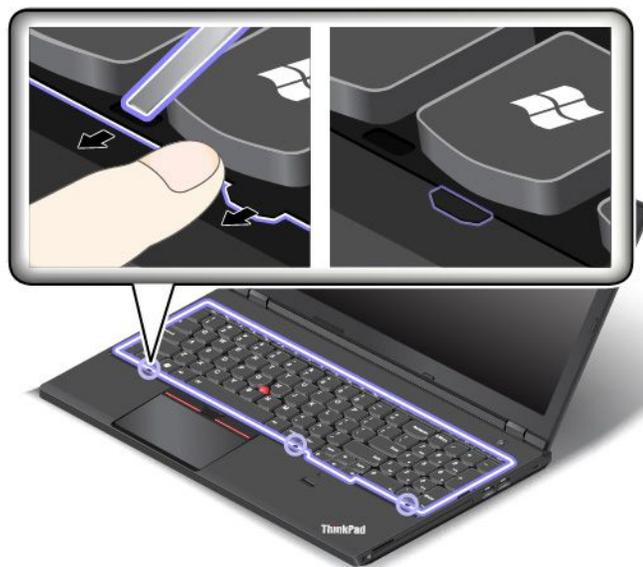
6. 図に示すようにマイナス・ドライバーをキー側面の隙間に挿入して、キーボード・フレームを後方にスライドさせます。キーボード・フレームとキーボード・ベゼルの間にはすき間がないことを確認します。
