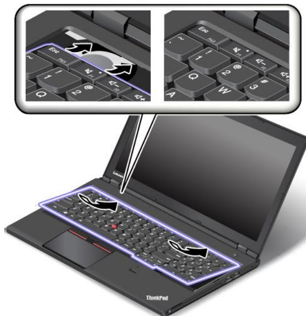
3. ねじの頭が完全に出ていることを確認してください。見えていない場合は、マイナス・ドライバーでキーボード・フレームを前方にスライドさせ、ねじの頭が見えるようにします。
