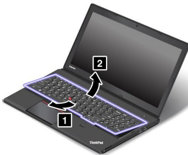
7. キーボードをパームレストに乗せ、コネクタを取り外します。次に、キーボードを取り外します。
