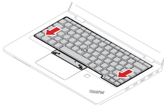
12. Ziehen Sie die Schrauben an, um die Tastatur zu befestigen.
