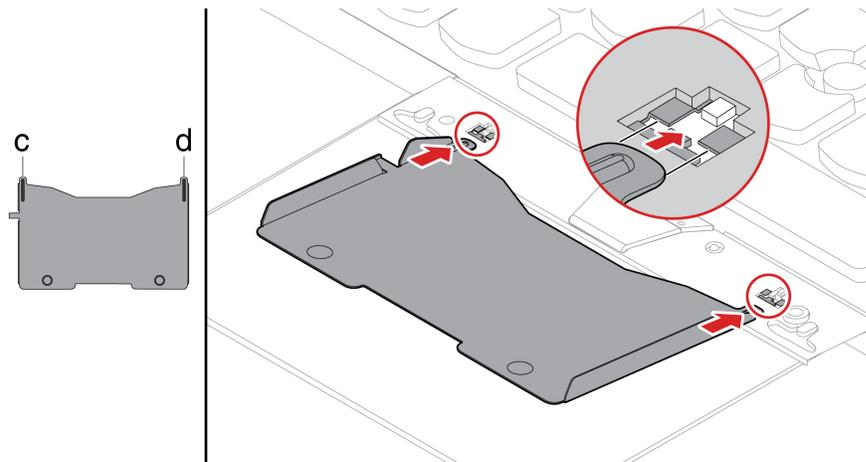
6. Drehen Sie das Werkzeug in die Richtung, wie in der Abbildung dargestellt, um die Tastatur freizugeben **1**. Schieben Sie die Tastatur in die durch die Pfeile **2** gekennzeichnete Richtung, um die Verriegelungen von der Tastaturblende freizugeben.
