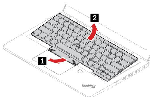
8. Legen Sie die Tastatur auf die Handablage, wie in der Abbildung dargestellt, und ziehen Sie die Steckverbinder ab. Entfernen Sie anschließend die Tastatur.
