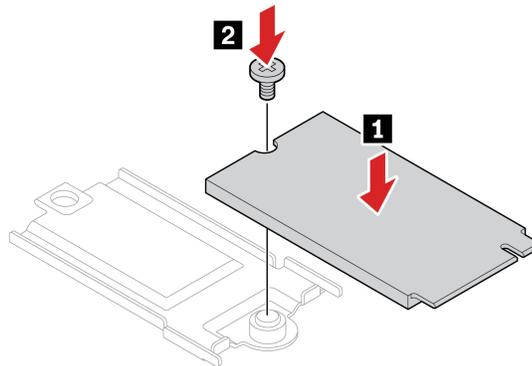
b. Drehen Sie das neue M.2 Solid-State-Laufwerk mit der Halterung um. Setzen Sie das neue M.2 Solid-State-Laufwerk in den Laufwerkschacht ein **1**. Kippen Sie die Halterung anschließend nach unten und bringen Sie die Schraube an, um die Halterung zu befestigen **2**.
