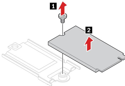
6. Installieren Sie ein neues M.2 Solid-State-Laufwerk:
