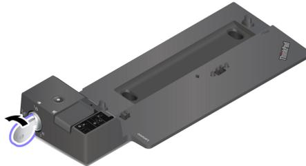
4. Richten Sie die Ecke oben links des Computers an den Führungsbolzen der Andockstation aus. Befestigen Sie Ihren Computer wie angezeigt an der Andockstation **1**, bis Sie einen Klick hören. Schieben Sie die Verriegelung in die angezeigte Richtung **2**.
