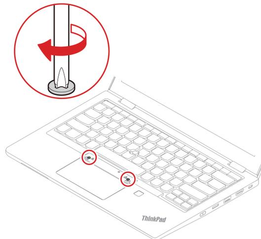
13. Nehmen Sie die neuen TrackPoint-Tasten aus der Verpackung der neuen Tastatur heraus. Setzen Sie die TrackPoint-Tasten, wie dargestellt, ein.
