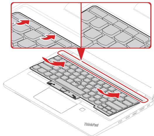
11. Schieben Sie die Tastatur in die dargestellte Richtung. Vergewissern Sie sich, dass die Verriegelungen unter dem Tastaturrahmen gesichert sind.
