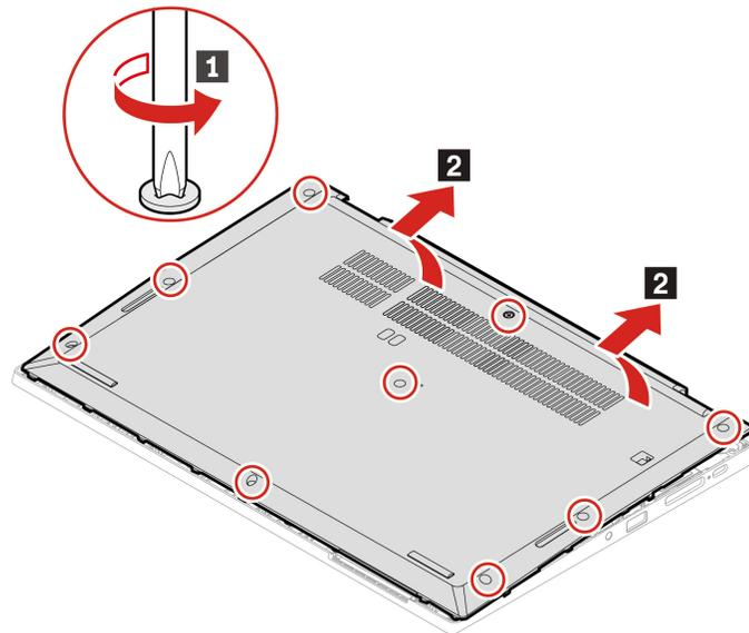
5. Befestigen Sie die Grundplattenabdeckung **1**. Vergewissern Sie sich, dass die Verriegelungen unter der Grundplattenabdeckung sicher sitzen **2**. Ziehen Sie dann die Schrauben fest, um die Baugruppe der unteren Abdeckung zu fixieren **3**.
