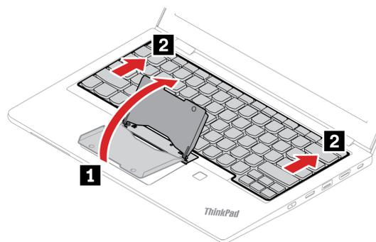
7. Schwenken Sie die Tastatur leicht nach oben **1** und drehen Sie dann die Tastatur um **2**.
