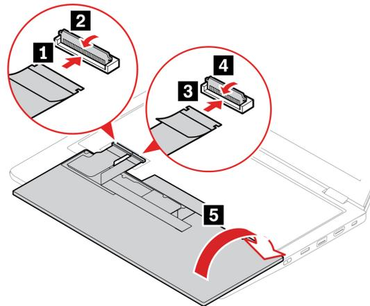
10. Setzen Sie die Tastatur wie abgebildet in die Tastaturblende ein. Vergewissern Sie sich, dass sich die obere Kante der Tastatur (die zum Bildschirm weisende Kante) unter der Tastaturblende befindet.
