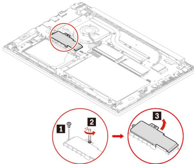
**Remarque :** Deux blocs thermiques sont fixés au-dessous du support long afin d'éviter toute surchauffe. Assurez-vous que les tampons thermiques ne sont ni retirés ni endommagés.
