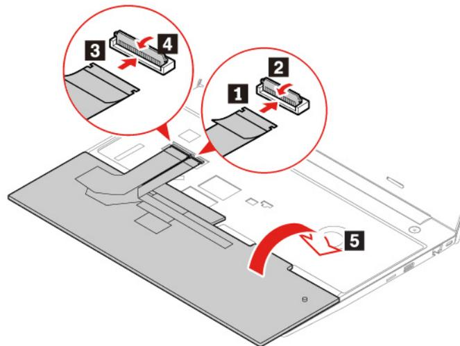
12. Insérez le clavier dans le panneau du clavier comme indiqué. Assurez-vous que le bord avant du clavier (le bord du côté de l'écran) est sous le panneau du clavier.
