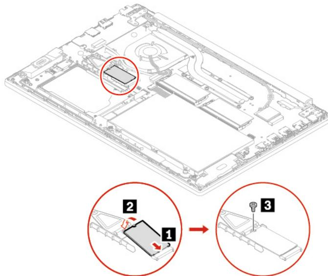
9. Réinstallez le support long dans le logement **1** **2**. Réinstallez ensuite la vis **3** et serrez la vis **4**.
