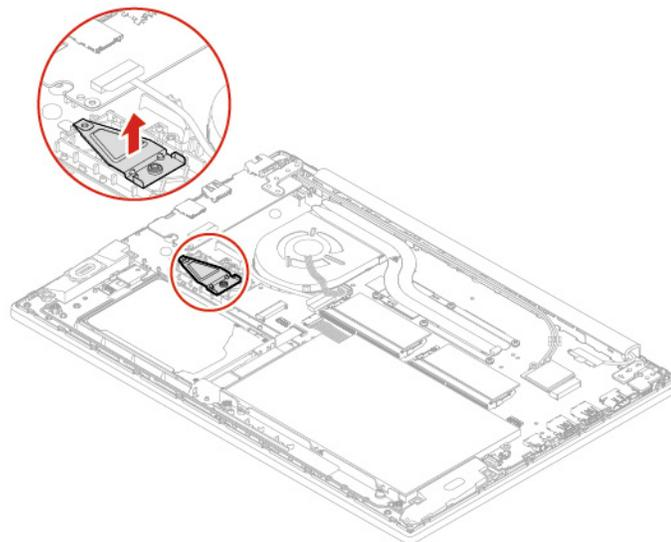
8. Insérez la nouvelle unité SSD M.2 dans le logement selon un angle d'environ 20 degrés **1** puis faites pivoter l'unité SSD M.2 vers le bas **2**. Installez la vis de fixation du nouveau disque SSD M.2 **3**.
