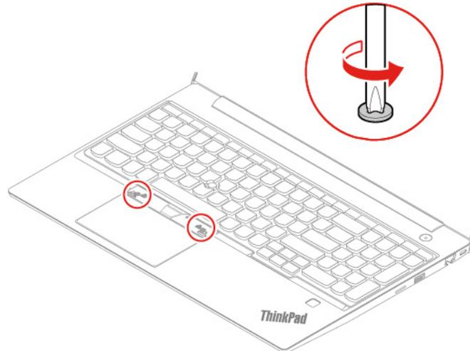
7. Insérez les onglets **c** et **d** dans les deux enfoncements à proximité des deux têtes de vis, comme indiqué.
