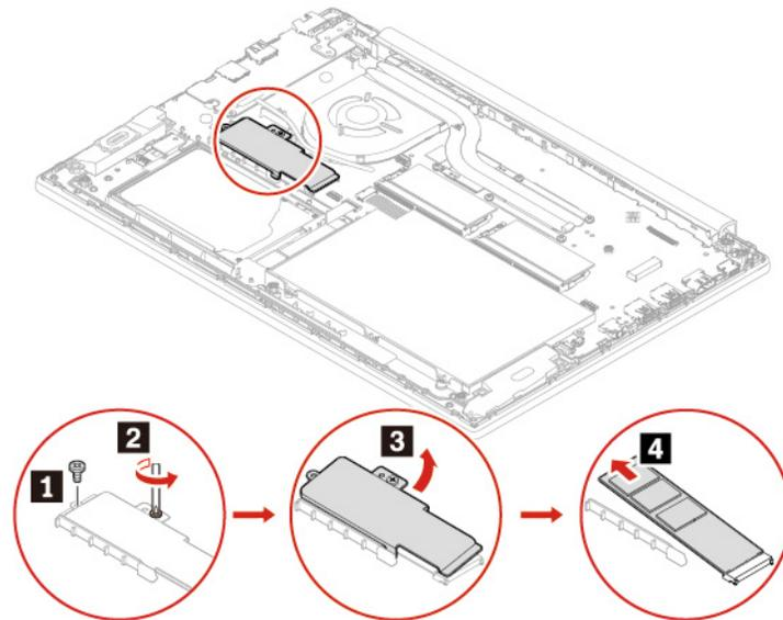
**Remarque :** Deux blocs thermiques sont fixés au-dessous du support long afin d'éviter toute surchauffe. Assurez-vous que les tampons thermiques ne sont ni retirés ni endommagés.
