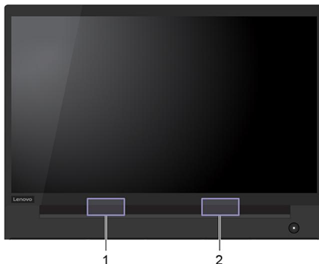
1. Antenne réseau local sans fil (auxiliaire)
