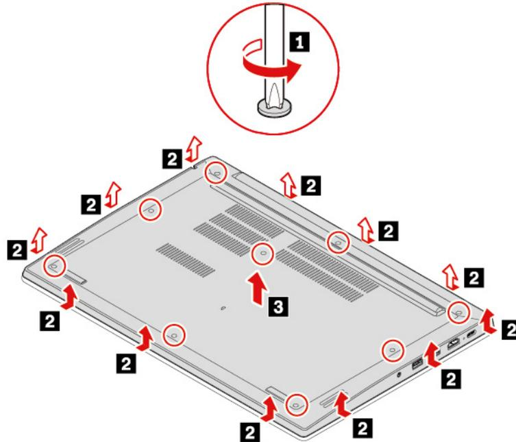
5. Installez le nouveau cache de protection de la base dans le logement **1** et assurez-vous que les loquets de la base sont correctement installés **2**. Serrez les vis **3**.
