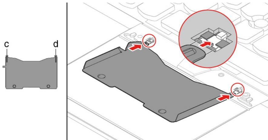
8. Faites pivoter l'outil dans la direction indiquée pour libérer le clavier **1**. Poussez le clavier dans la direction indiquée par les flèches **2** afin de débloquer les loquets du panneau du clavier.
