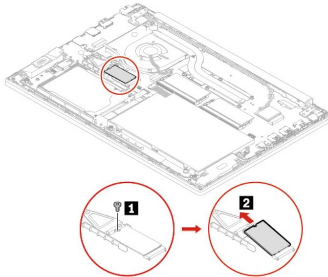
**Remarque** : Retirez le support court si vous souhaitez remplacer le disque SSD M.2 court par un disque SSD M.2 long.
