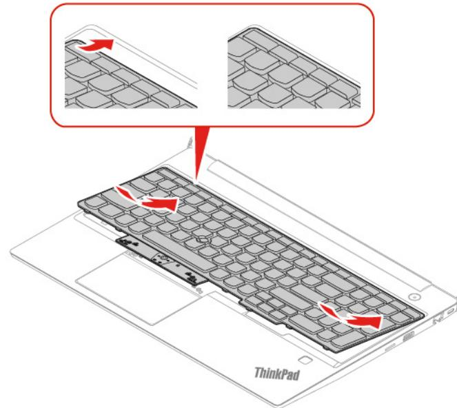
13. Faites glisser le clavier dans le sens indiqué par les flèches. Assurez-vous que les loquets sont fixés sous le cadre du clavier.
