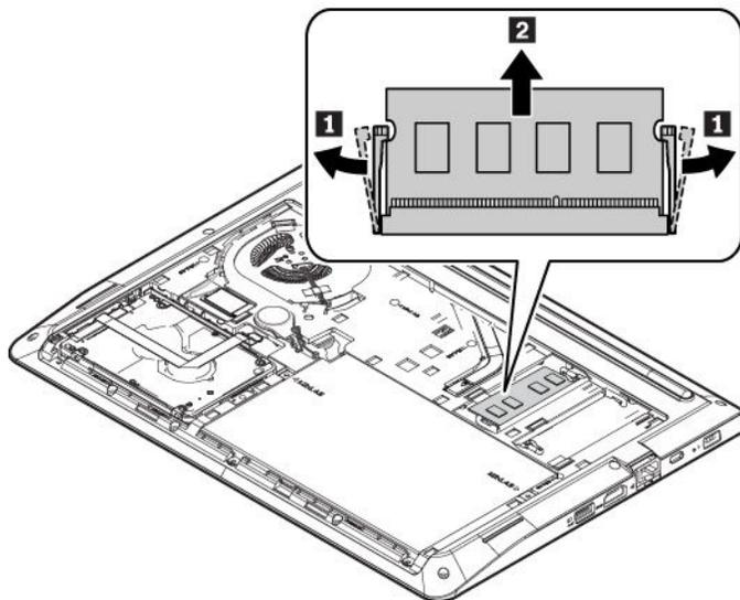
7. 新しいメモリー・モジュールを約 20 度の角度でメモリー・スロットに差し込みます **1**。カチッと音がして正しい位置に収まるまでメモリー・モジュールを手前に倒します **2**。メモリー・モジュールがメモリー・スロットにしっかり固定されていて、簡単に動かないことを確認します。
