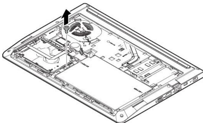
7. 図のようにケーブルが通っているブラケットごとストレージ・ドライブを取り外します。
