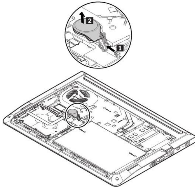
7. 新しいコイン型電池を取り付け **1**、コネクターを取り付けます **2**。
