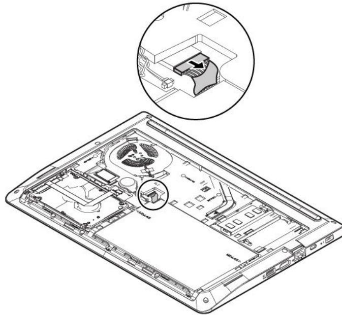
6. コネクターを取り外し **1**、コイン型電池を取り外します **2**。
