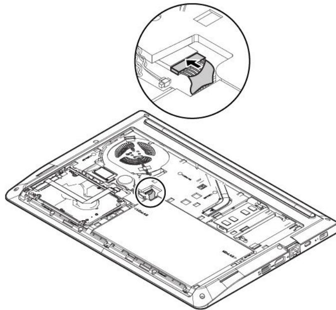
9. 下部カバーを取り付け直します。92 ページの「下部カバーの交換」を参照してください。
