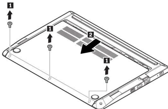
5. 図に示すように、下部カバーをベース・カバー・アセンブリのフレームに合わせます。下部カバーを所定の位置に押し込みます。ねじを取り付けて下部カバーを固定します。
