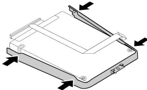
10. 新しいストレージ・ドライブを取り付け、下方向に倒します。新しいストレージ・ドライブが所定の位置に取り付けられていることを確認します。
