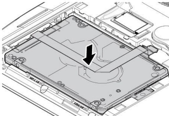
11. ねじ **1** を取り付けて、新しいストレージ・ドライブを固定します。
