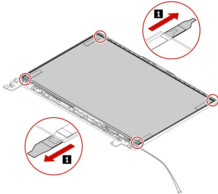
2. LCD パネルを裏返し、図のように LCD ケーブルを LCD パネルから取り外します。
