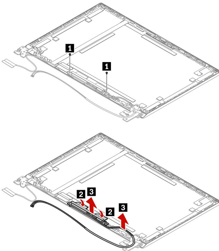
ワイヤレス LAN アンテナ・アセンブリーを LCD 背面カバー・アセンブリーから取り外します。
