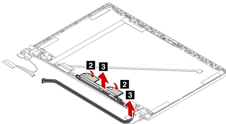
ワイヤレス LAN アンテナ・アセンブリーを LCD 背面カバー・アセンブリーから取り外します。
