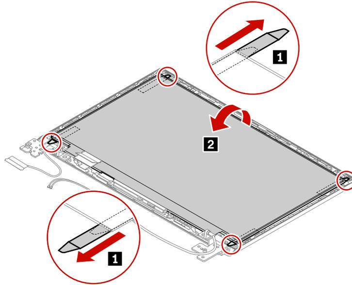
2. 図のように LCD ケーブルを LCD パネルから取り外します。
