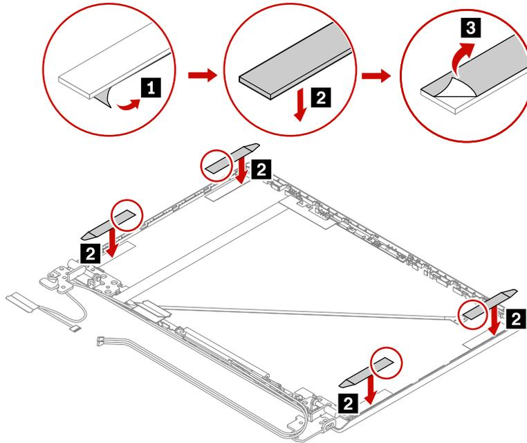
2. 図のように LCD ケーブルを LCD パネルに接続します。LCD パネルを裏返して、テープで LCD パネルを固定します。
