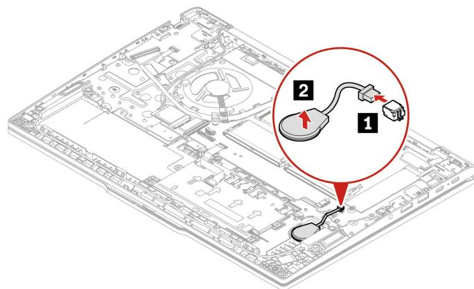
ステップ2. 逆の順序でコイン型電池を取り付けます。
