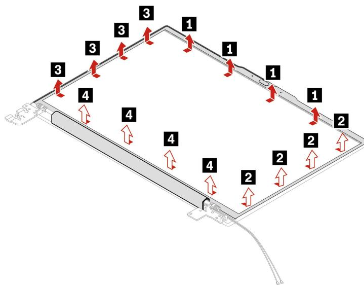
ステップ 2. 逆の順序で LCD ベゼルを取り付けます。
