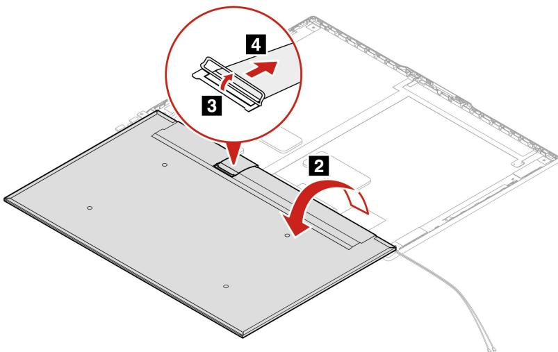
ステップ2. 逆の順序でLCDパネルおよびLCDカバーを取り付けます。
