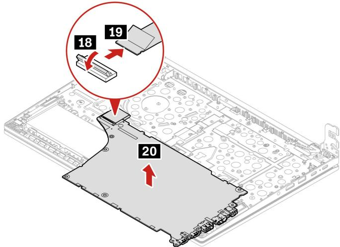
ステップ2. 逆の順序でシステム・ボードを取り付けます。
