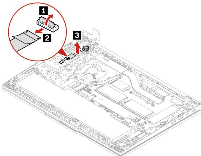
ステップ 2. 逆の順序で電源ボタン(指紋センサーおよび指紋センサー・ケーブル付き/指紋センサーおよび指紋センサー・ケーブルなし)を取り付けます。
