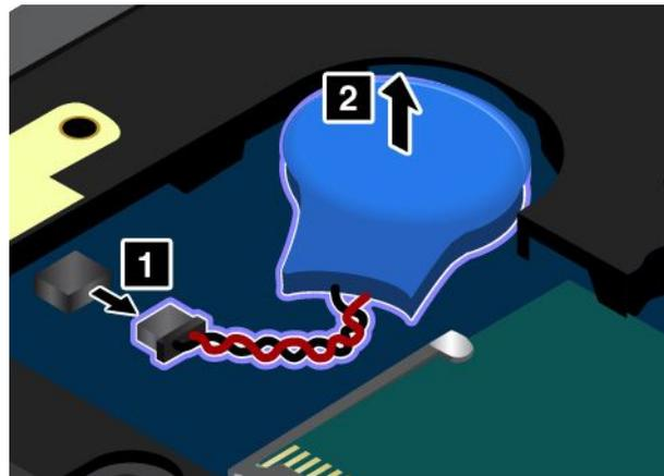
6. Installez la nouvelle batterie à pile cellulaire **1**, puis branchez le connecteur **2**.
