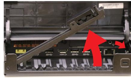
**3** 電源アダプター（付属品）、LAN ケーブルを接続します。必要に応じて HDMI ケーブルや Web カメラ等を接続します。
