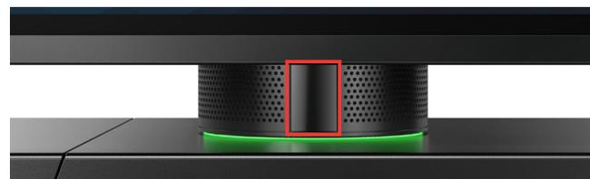
スタンバイ中の ThinkSmart Hub 500 は、タッチパネルディスプレイにダブルタップすることで、すぐに点灯します。加えて、本体前面側のディスプレイ下柱部分には、赤外線人感センサーを内蔵。人の動きを検知して自動起動、ルームに着席したらスムーズに会議を開始、終了後、参加者が離席し、部屋が無人になるとディスプレイを消灯して待機、といった運用が可能です。
