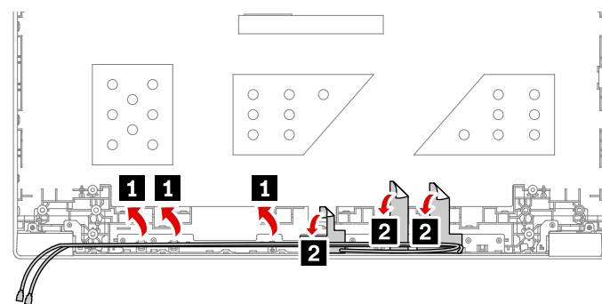
ワイヤレス LAN アンテナ・アセンブリーを LCD 背面カバー・アセンブリーから取り外します。
