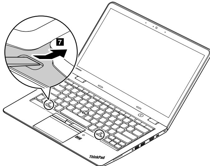
4. ツールの十字の方でねじを締め、キーボードを定位置に固定します。
