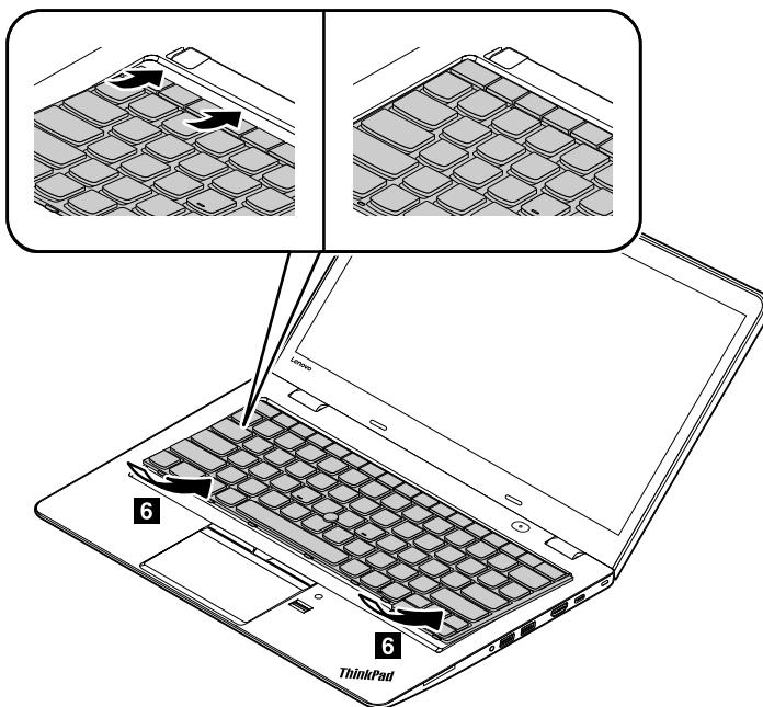
3. ねじの頭が完全に出ていることを確認してください。見えていない場合は、ツールの平らな方でキーボード・フレームを前方にスライドさせ、ねじの頭が見えるようにします。
