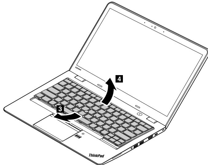
4. キーボードをパームレストに乗せ、コネクターを取り外します。次に、キーボードを取り外します。
