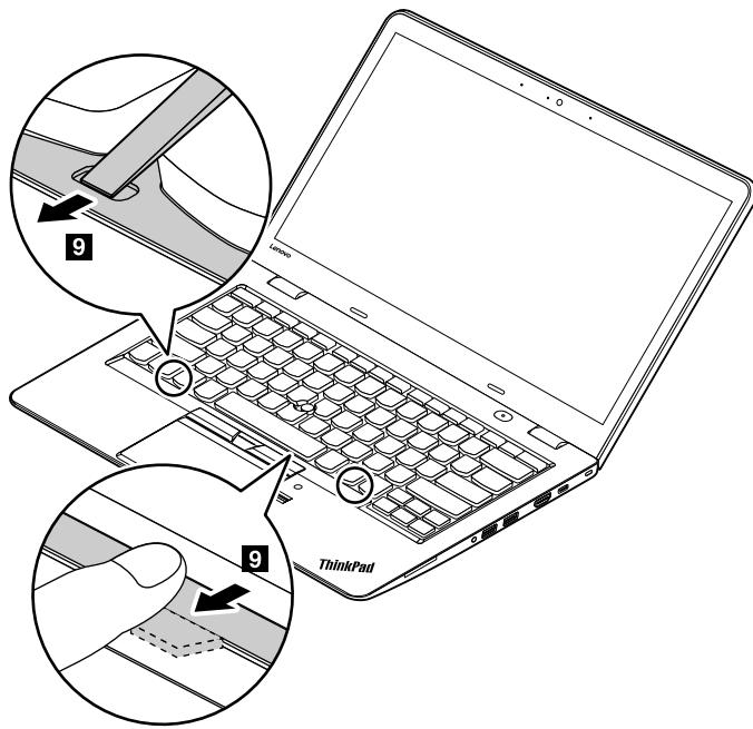
6. 図に示すようにツールの平らな方をキーボードの側面に挿入して、キーボード・フレームを後方に押し込みます。キーボード・フレームとキーボード・ベゼルの間にすき間がないことを確認します。
