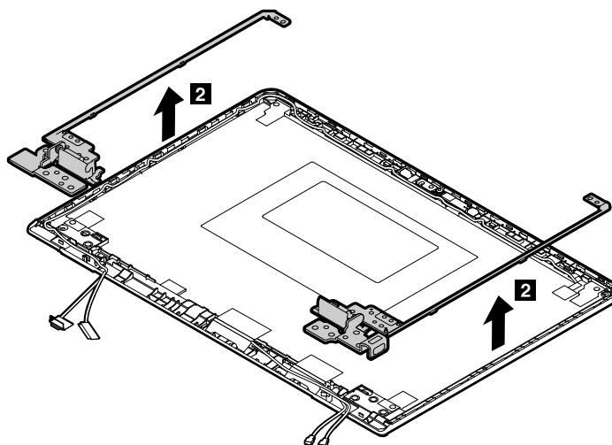
カバーがプラスチック製のコンピューター・モデルのヒンジ・キットの取り外し手順
