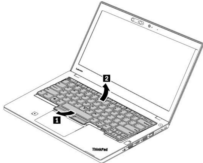
キーボードをパームレストに乗せ、コネクターを取り外します。次に、キーボードを取り外します。
