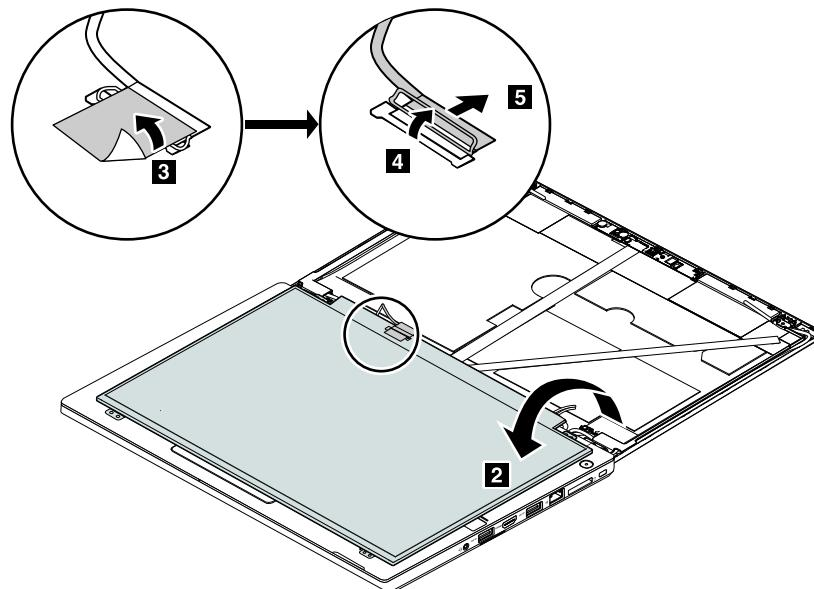
取り付け時の注意: LCD ケーブルのコネクターがしっかりと接続されていることを確認してください。
