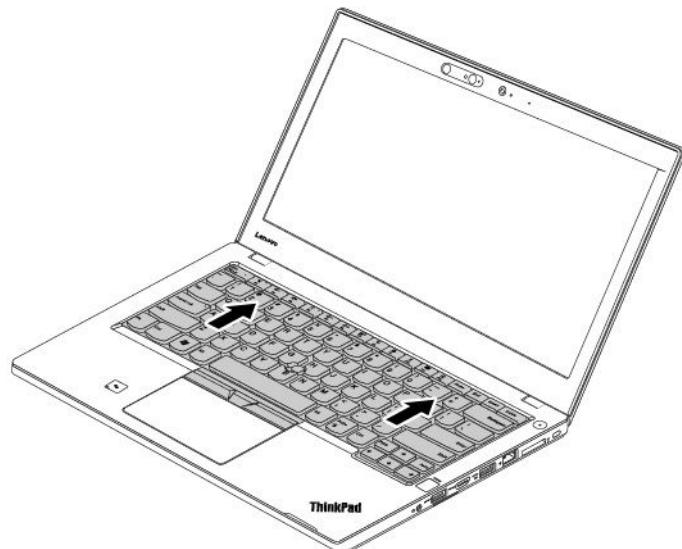
キーボードの底面のコネクターが見えるまで、矢印の方向にキーボードを持ち上げます**1**。次に、矢印で示すようにキーボードを裏返します**2**。
