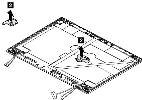
LCD ヒンジ・アセンブリーおよび LCD 背面カバー保持ブラケット・アセンブリーの取り外し手順 (WQHD パネル付きモデルの場合)
