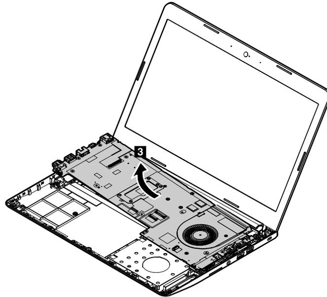
システム・ボードを裏返します。サーマル・ファン・アセンブリーはシステム・ボードの反対側にあります。次に、システム・ボードに接続するケーブルを取り外します。
