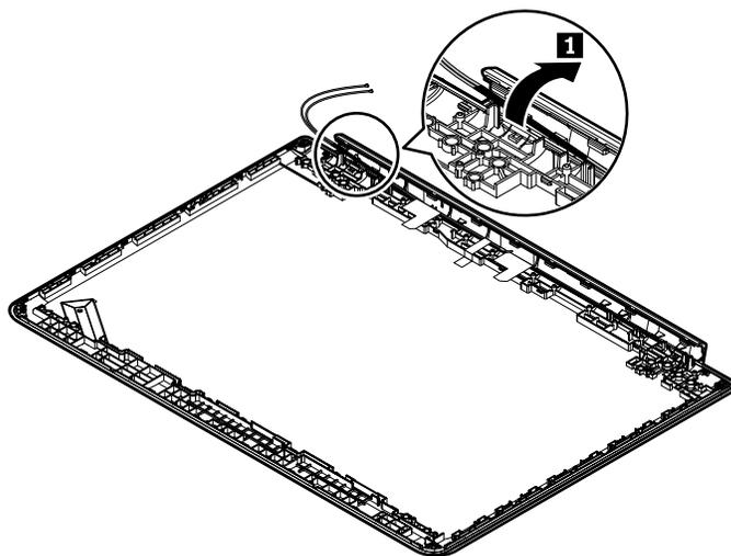
ワイヤレス LAN アンテナ・アセンブリーを LCD 背面カバー・アセンブリーから取り外します。
