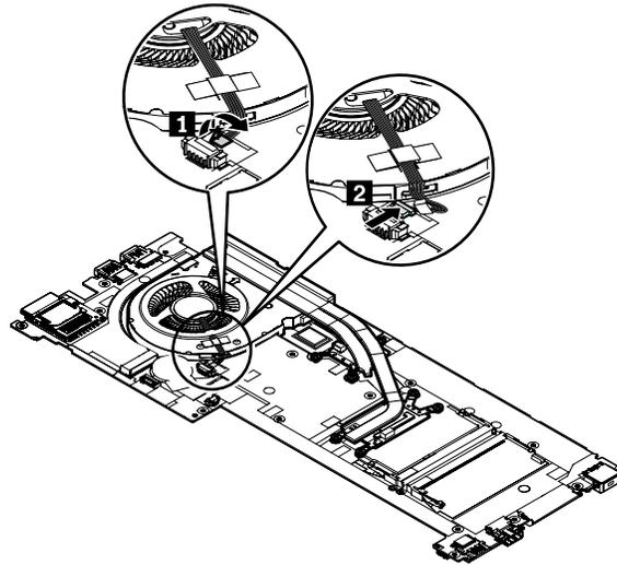
図に示されているように、アルファベット順 (昇順) にねじを緩めます。サーマル・ファン・アセンブリーを取り外します。
