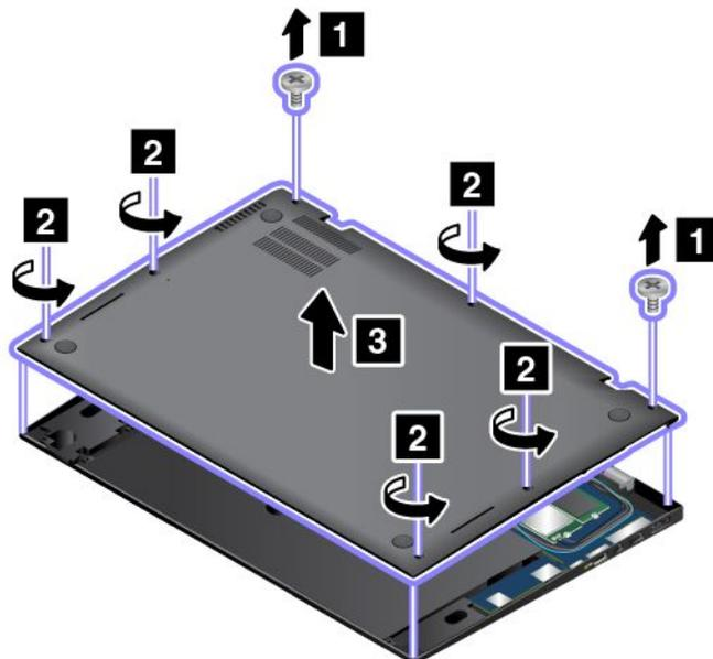
4. Installieren Sie die neue untere Abdeckung **1**, befestigen Sie anschließend die Schrauben **2** und bringen Sie dann die Schrauben **3** an.
