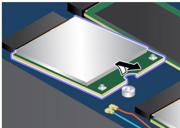
5. Richten Sie die Kante der neuen Karte für drahtlose WAN-Verbindungen mit der Einkerbung an der Aussparung des zugehörigen Steckplatzes aus. Setzen Sie dann die Karte vorsichtig in einem Winkel von ca. 20 Grad in den Steckplatz ein.
