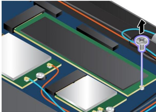
5. Entfernen Sie das Solid-State-Laufwerk.
