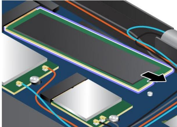
6. Installieren Sie das neue Solid-State-Laufwerk.
