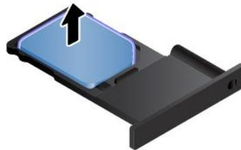
5. Installieren Sie die neue Micro-SIM-Karte im Karteneinschub.
