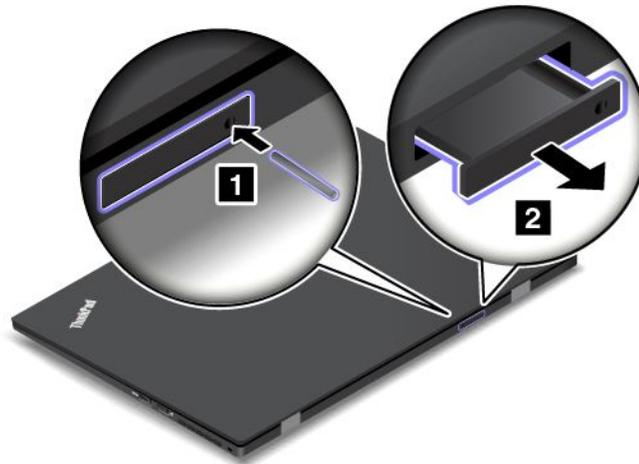
4. Wenn Sie eine Micro-SIM-Karte installieren, fahren Sie mit Schritt 5 fort. Wenn Sie eine Micro-SIM-Karte austauschen, nehmen Sie zuerst die alte Micro-SIM-Karte vorsichtig aus dem Einschub.
