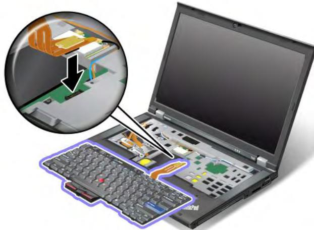
2. 插入鍵盤。確定鍵盤的背緣在框架下方，如箭頭所示。
