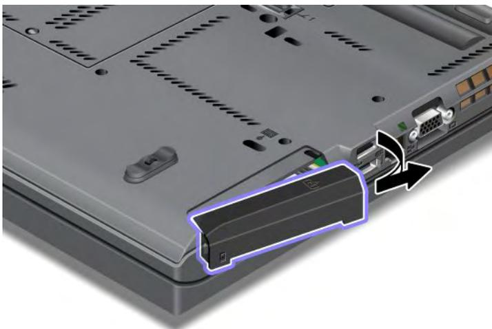
6. 拉出卡栓以取出固態硬碟。
