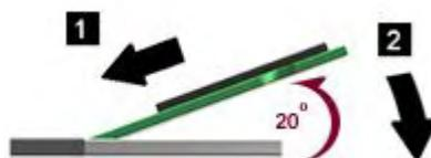
7. 將 SO-DIMM 向下旋轉，直到它卡入定位。
