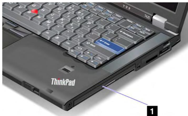
2. 將可更換的裝置插入機槽，然後將裝置牢固地按入接頭。
