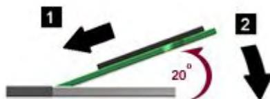
7. Ruotare il modulo SO-DIMM verso il basso fino a quando non si posiziona correttamente con uno scatto.
