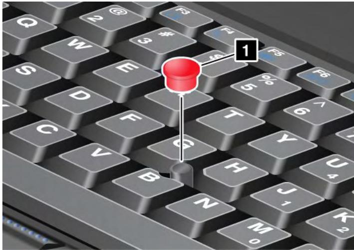
**Nota:** se si sostituisce la tastiera, viene fornita una nuova tastiera con cappuccio standard. Se si desidera, è possibile conservare il cappuccio della tastiera precedente e utilizzarlo con quella nuova.
