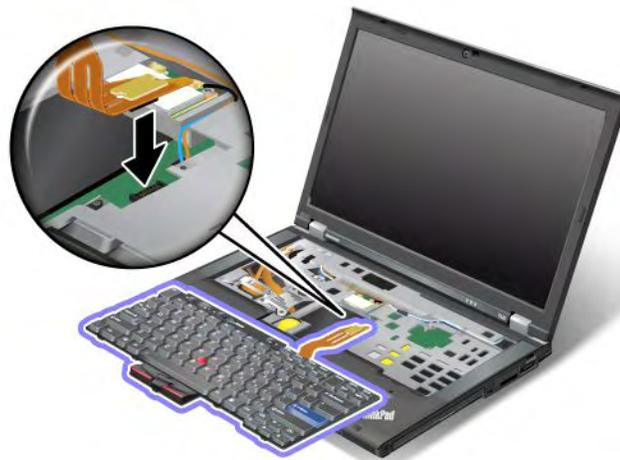
2. Inserire la tastiera. Verificare che i bordi posteriori della tastiera siano al di sotto della struttura, come indicato dalle frecce.
